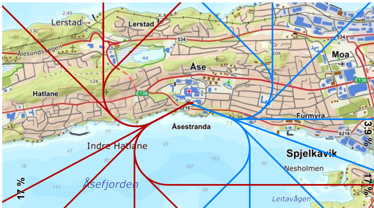
Figur 7-2. Traséer for landing (blå) og avgang (rød) på rullebane 27, M 1:25 000.
