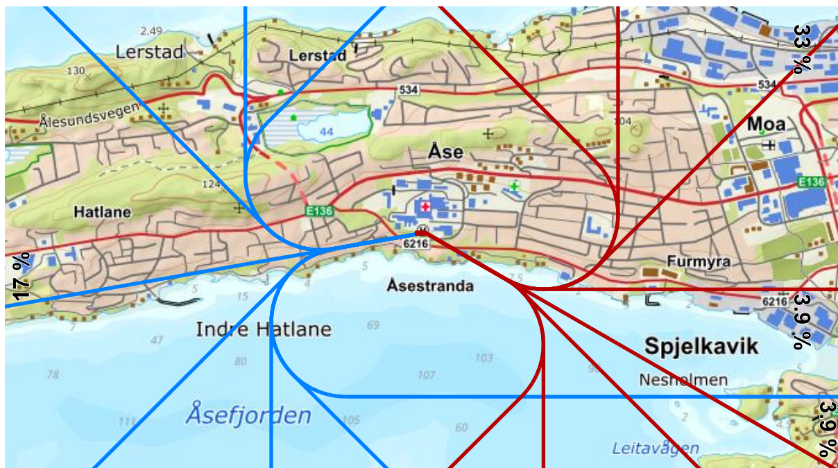
Figur 7-1. Traséer for landing (blå) og avgang (rød) på rullebane 09, M 1:25 000.
