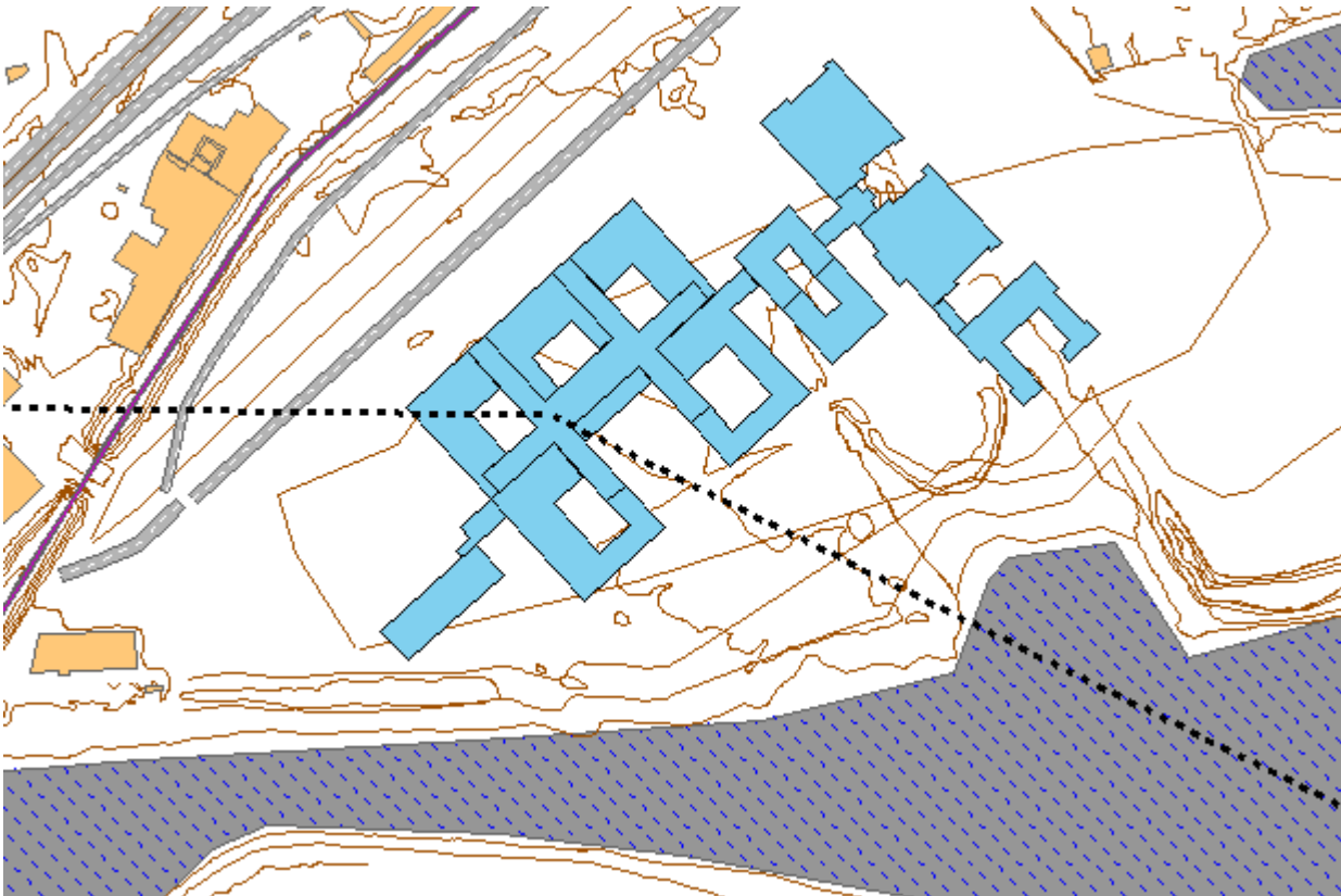
Figur 2 Svart stiplet linje viser traséer for inn-og utflygning som er benyttet i beregningene
