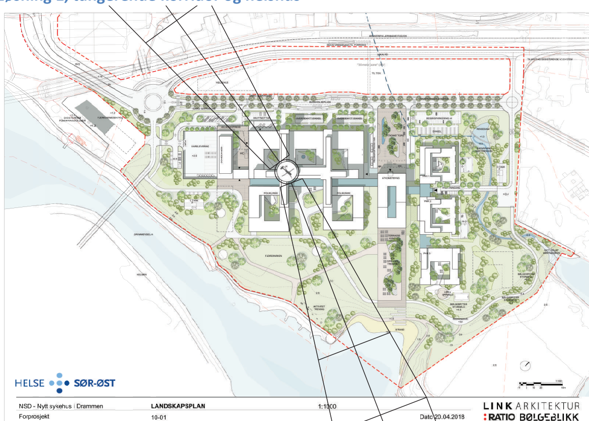
Figur 2, Inn- og utflygingsflater, tangering av heishus
